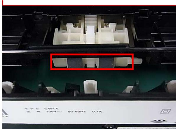
4. 灰色の給紙ローラーを素手で触らないように注意しながら、水で湿らせた布でローラー全体を回転させながら、清掃します。
