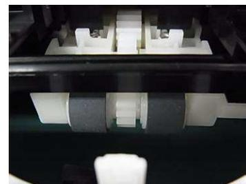
5. 清掃が終了後、給紙ローラーの水分が乾燥したら、背面ユニットを元に戻し、用紙トレイをセットしてください。
