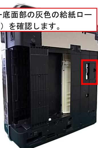
4. 灰色の給紙ローラーを素手で触らないよう注意しながら、水で湿らせた布でローラー全体を回転させながら、清掃します。
