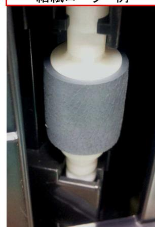
5. 清掃が終了したら、プリンターを元の向きに戻します。給紙ローラーの水分が乾燥したら、用紙カセットをセットしてください。
